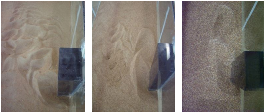
شکل ۸: فرم بستر در تکیه گاه مستطیلی برای بستر با اندازه ذرات ۰/۳۵، ۰/۷، ۱/۵ میلی متر (از چپ به راست)
