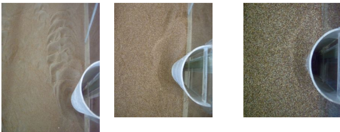
شکل ۱۰: فرم بستر در تکیه گاه نیم دایره برای بستر با اندازه ذرات ۰/۳۵، ۰/۷، ۱/۵ میلی متر (از چپ به راست)
